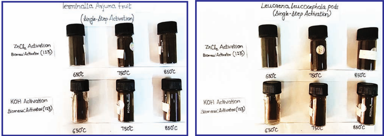
टर्मिनलिया अर्जुन फल-व्युत्पन्न सक्रिय कार्बन अलग-अलग सक्रियकर्ताओं ( ZnCl_2, KOH ) के साथ अलग-अलग तापमान पर
